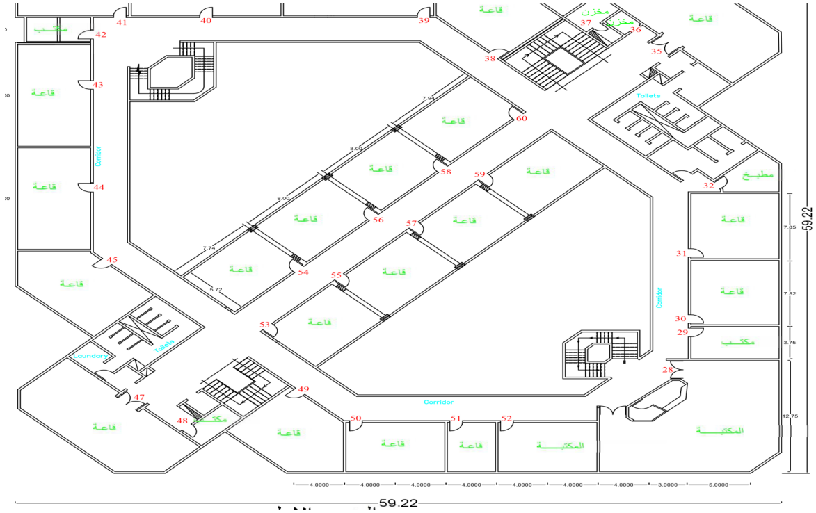
شكل (ع): مخطط توضيحي لعملية ترقيم مصادر انطلاق صافرات الإنذار.
