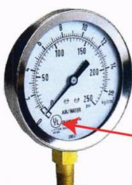
2 - مقياس الضغط (Pressure Gauge): جهاز يركب على خط السحب وخط الدفع من المضخة لمعرفة الضغط. ولا يجب أن يقل تدريج مقياس الضغط عن ضعفي الضغط التشغيلي للمضخات
